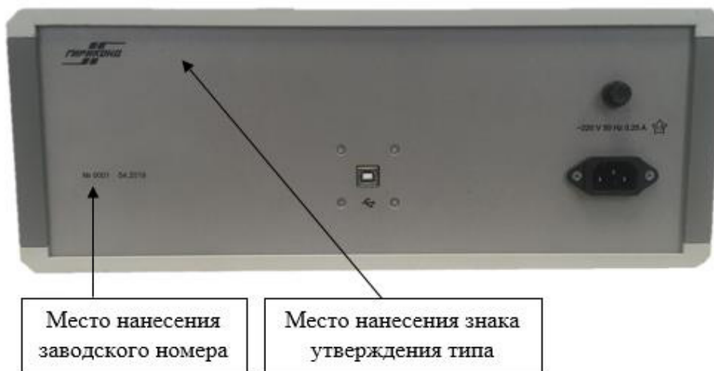
Рисунок 3 — Общий вид приборов МЦЕ-23А с указанием места нанесения заводского номера и знака утверждения типа
