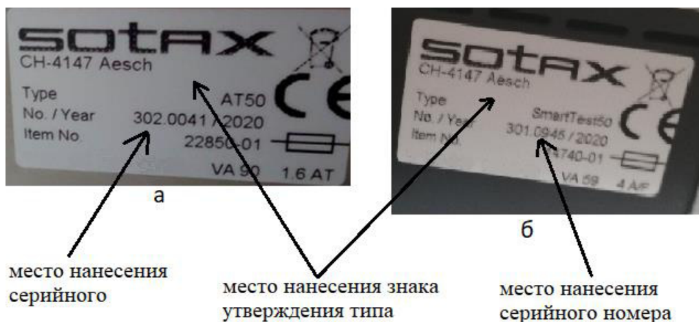
Рисунок 3 – Маркировочные таблички тестеров, где а) для модификации AT50; б) для модификации ST50
