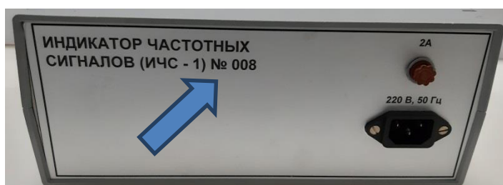
Рисунок 4 – Место нанесения заводского номера. а - первичный преобразователь; б - УЧС-2М; в - ИЧС-1.
