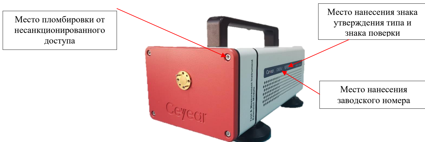
Рисунок 1 – Общий вид МРЧД в первом исполнении
