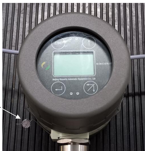
Рисунок 2 - Схема пломбировки от несанкционированного доступа
