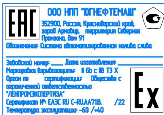
Рисунок 2 – Места нанесения знака утверждения типа и заводского номера ИС
