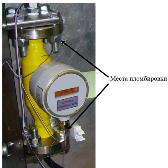
Рисунок 8 – Схема пломбировки плотномера
