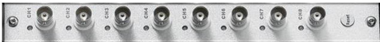
Рисунок 14 – Общий вид лицевой панели аппаратуры бескорпусного исполнения в виде электронной платы модификации ONYX-Xr
