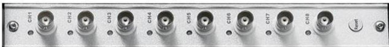
Рисунок 15 – Общий вид лицевой панели аппаратуры бескорпусного исполнения в виде электронной платы модификации ONYX-XCr
