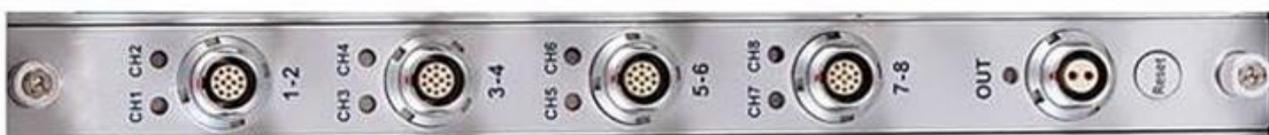
Рисунок 16 – Общий вид лицевой панели аппаратуры бескорпусного исполнения в виде электронной платы модификации ONYX-Sr
