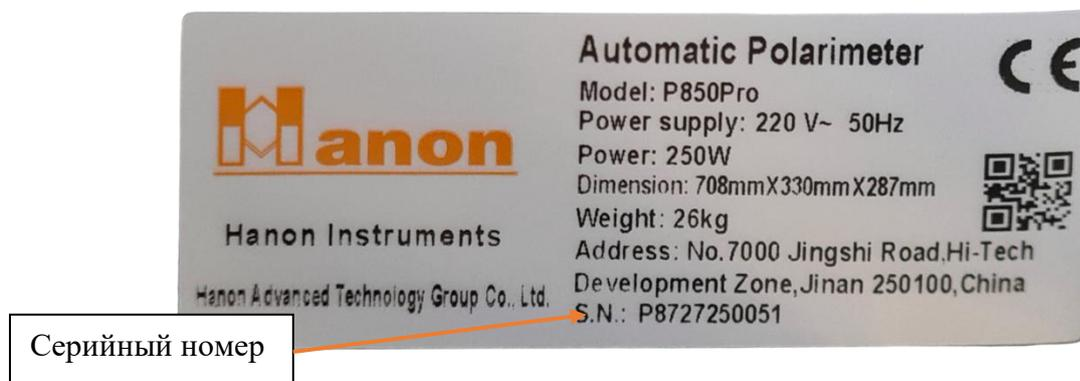
Рисунок 2 – Идентификационная табличка поляриметров
