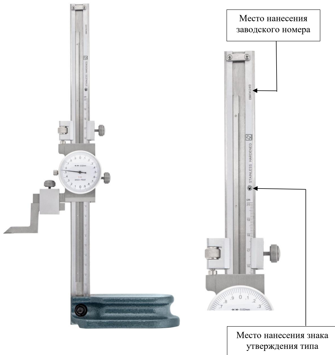
Рисунок 2 – Общий вид штангенрейсмасов модели ШРК с указанием мест нанесения заводского номера и знака утверждения типа
