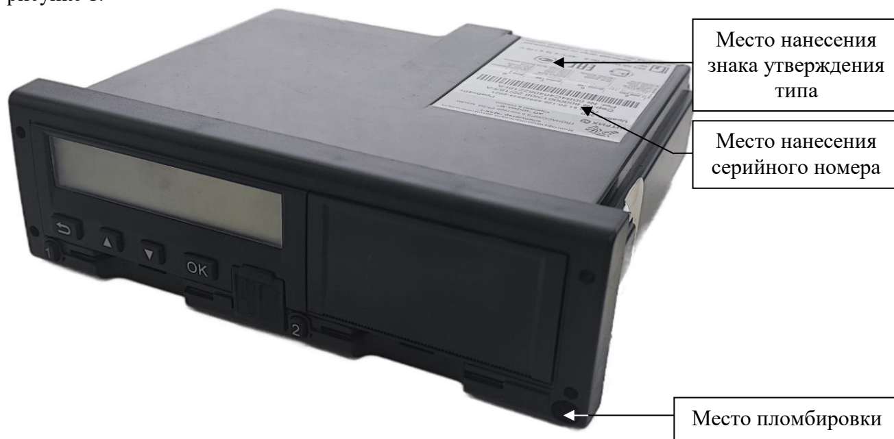
Рисунок 1 – Общий вид тахографов, обозначение мест нанесения знака утверждение типа, серийного номера, схема пломбировки от несанкционированного доступа
