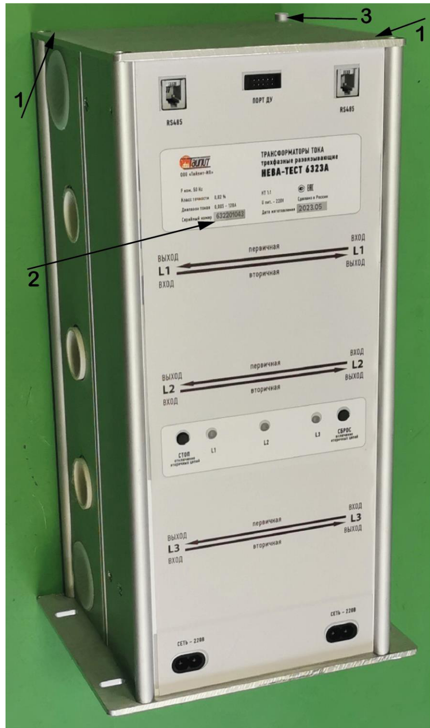
Рисунок 1. Внешний вид трансформаторов. Места нанесения защитной наклейки (1), место нанесения заводского номера (2), место нанесения знака поверки (3).
