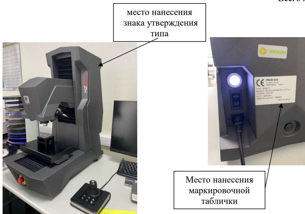
Рисунок 1 - Общий вид твердомера Виккерса HZ10-4
