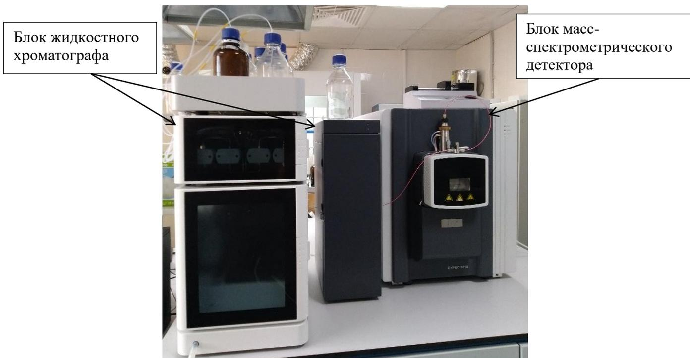
Рисунок 1 – Общий вид хромато-масс-спектрометров жидкостных EXPEC 5210
