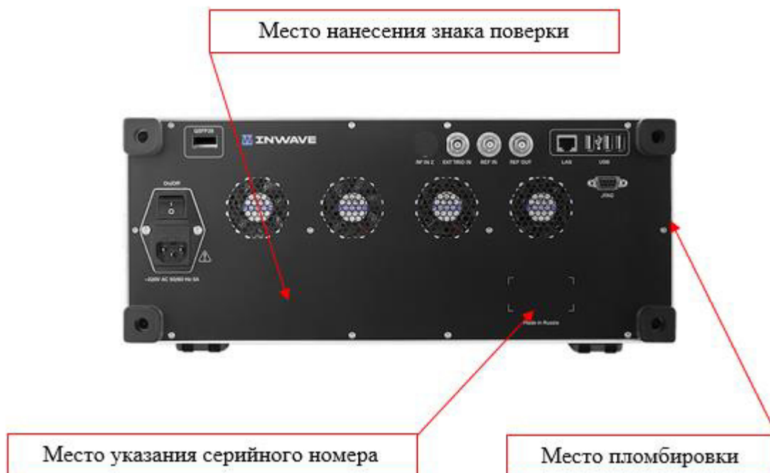
Рисунок 2 – Схема пломбировки от несанкционированного доступа и место нанесения серийного номера, идентифицирующего каждый экземпляр СИ, место нанесения знака поверки
