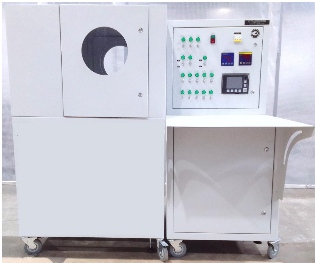
Рисунок 1 – Общий вид установки вакуумной потоковой масс-спектрометрической эталонной УВПМЭ
