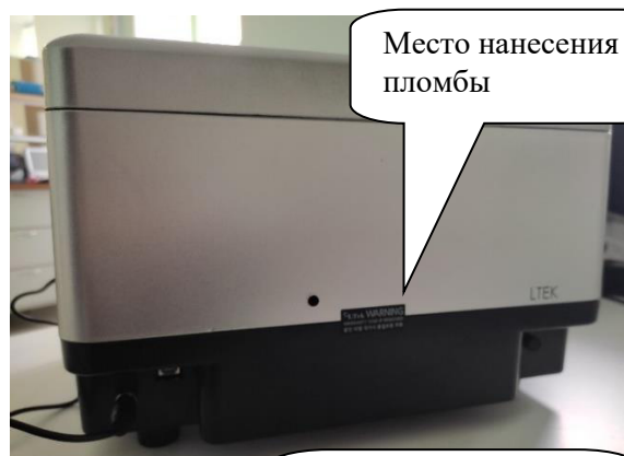
Рисунок 1 – Общий вид спектрофотометров микропланшетных INNO
