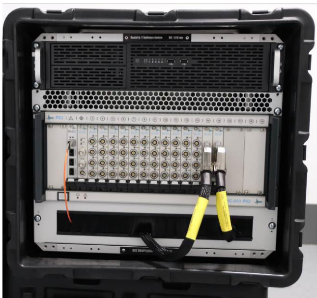
Рисунок 3 – Станция сбора данных БЛИЖ.408310.002.132-01. Комплекс измери- тельный MIC-553PXI и PromPC
