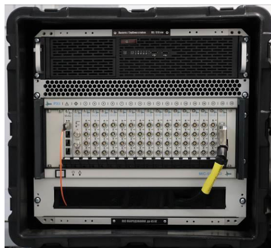
Рисунок 2 – Станция сбора данных БЛИЖ.408310.002.132. Комплекс измерительный МІС-553РХІ и PromPC
