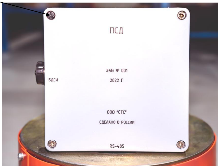
Рисунок 3 – Место пломбировки ПСД от несанкционированного доступа
