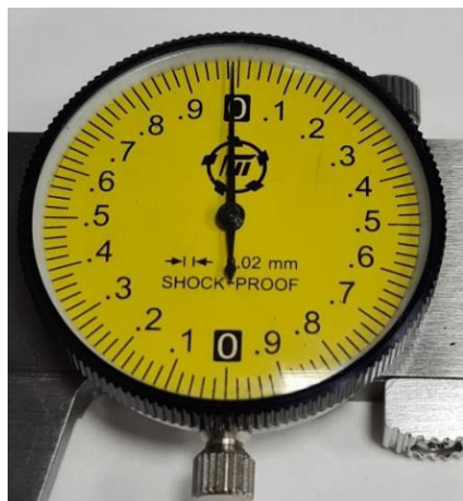
Рисунок 9 – Общий вид круговой шкалы отсчетного устройства штангенциркулей
