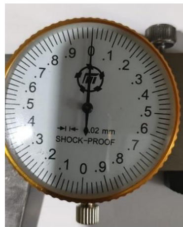
Рисунок 9 – Общий вид круговой шкалы отсчетного устройства штангенциркулей
