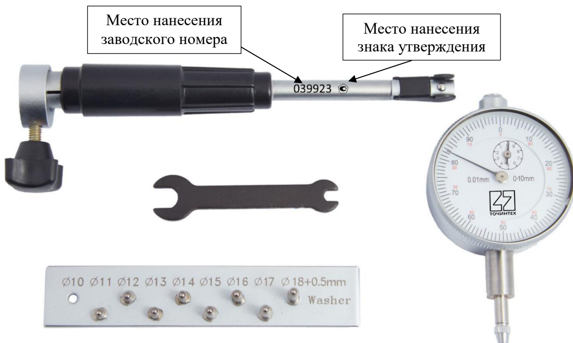
Рисунок 1 – Общий вид нутромеров с указанием мест нанесения заводского номера и знака утверждения типа
