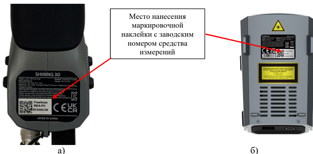
Рисунок 3 - Место расположения маркировочных наклеек с указанием заводского номера приборов оптических координатно-измерительных бесконтактных Shining 3D модификаций: а) FreeScan Combo; б) FreeScan Trio
