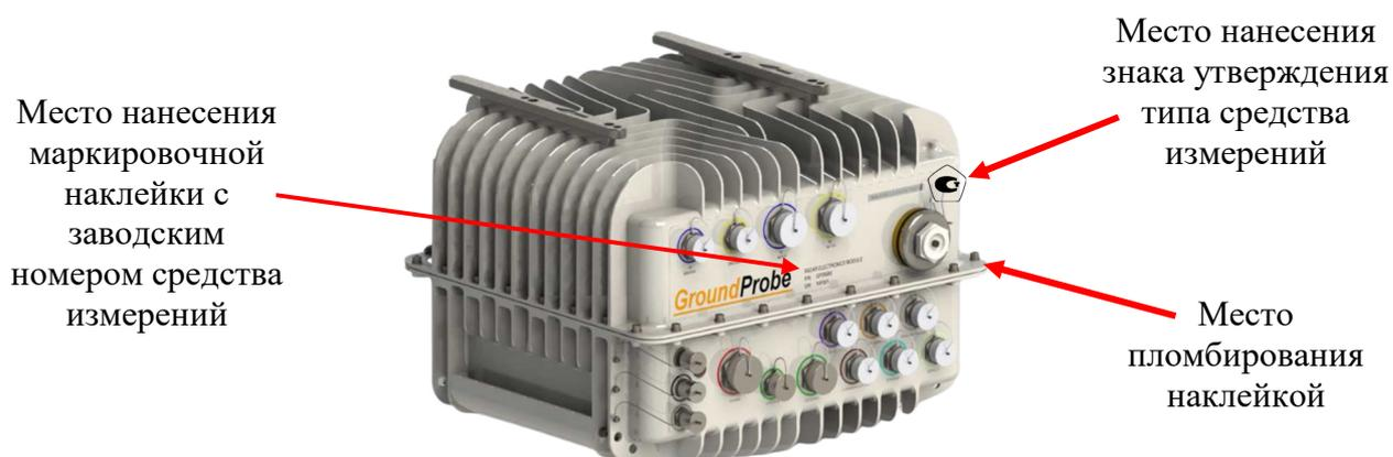
Место нанесения маркировочной наклейки с заводским номером средства измерений
