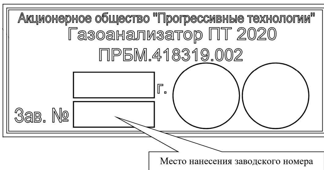
Рисунок 2 - Общий вид таблички с маркировкой газоанализатора
