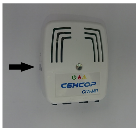
Рисунок 3. Место пломбирования газосигнализаторов СГХ(-Р) и СГХ-М(-МП)
