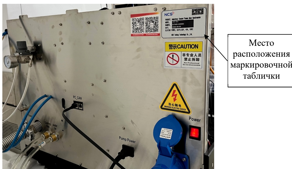
Рисунок 2 – Вид задней стенки масс-спектрометра с местом расположения маркировочной таблички
