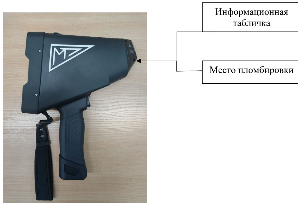
Рисунок 1 - Общий вид анализаторов, места нанесения информационной таблички с указанием серийного номера и схемы пломбировки от несанкционированного доступа
