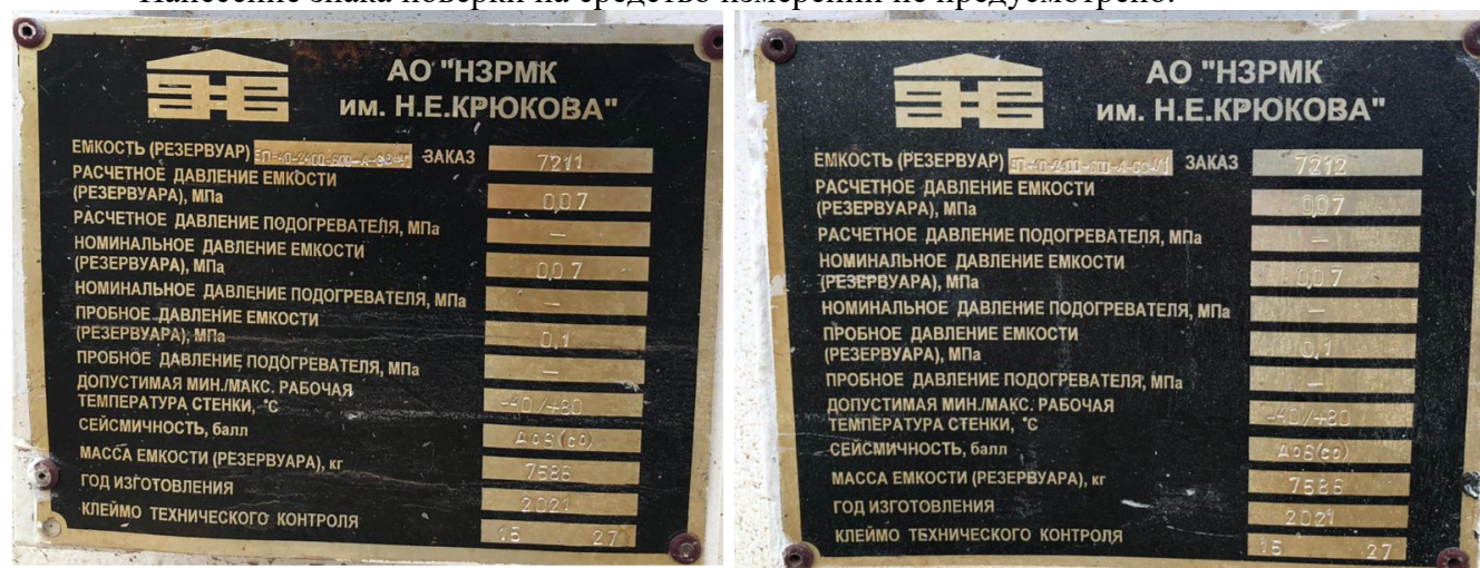
Рисунок 1 – Маркировочные таблички резервуаров
