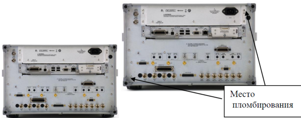
Рисунок 6 – Задняя панель ВАЦ N5224В с указанием места пломбирования от несанкционированного доступа
