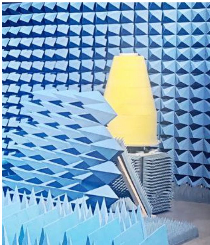
Рисунок 5 – Общий вид ОПУ с тумбой радиопрозрачной многосекционной за поглощающим экраном
