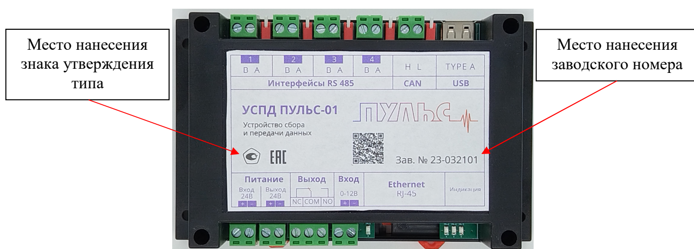
Рисунок 1 – Общий вид УСПД с указанием места нанесения знака утверждения типа и заводского номера
