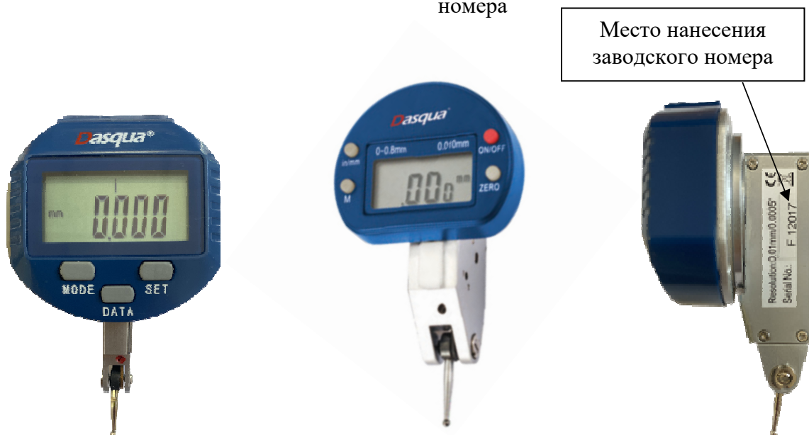
Рисунок 10 – Общий вид индикаторов модели 5410 с указанием места нанесения заводского номера
