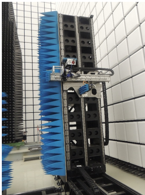
Рисунок 3 - Внешний вид прецизионного четырехкоординатного Т-сканера РЛТГ.411722.004
