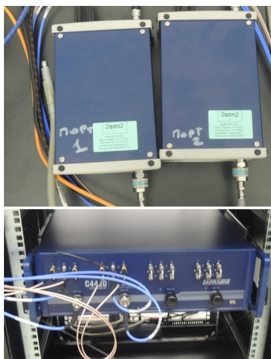
Рисунок 7 – Лицевая панель ВАЦ С4420 с модулями расширения частотного диапазона
