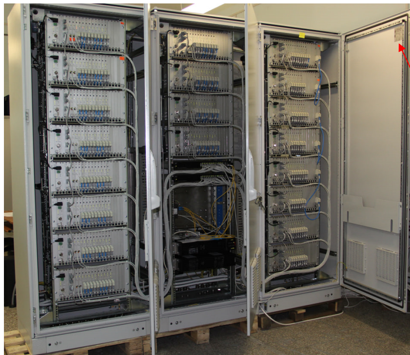
Рисунок 6 – Внешний вид шкафа систем ТИК-RVM в распределенном исполнении, место нанесения заводского номера, модификации и измерительного исполнения
