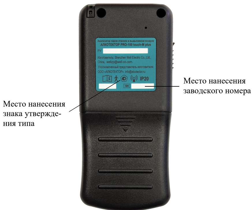
Рисунок 3 – Общий вид анализаторов с указанием места нанесения знака утверждения типа и места нанесения заводского номера
