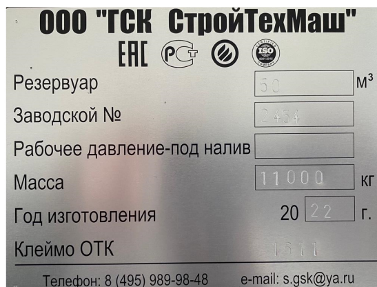
Рисунок 1 – Маркировочные таблички резервуаров
