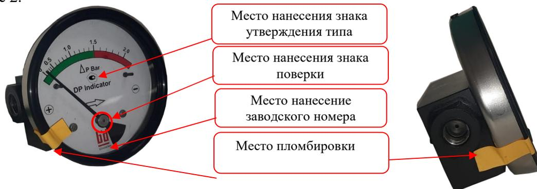
Рисунок 1 схема пломбировки манометров с местами нанесения знака поверки, знака утверждения типа и заводского номера
