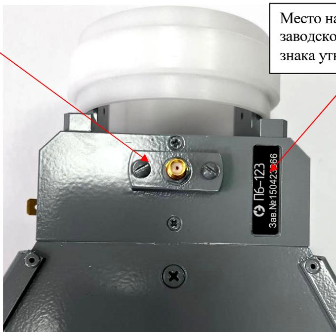
Рисунок 1 – Общий вид антенны Пб-123 с соединителем SMA-female (розетка)
