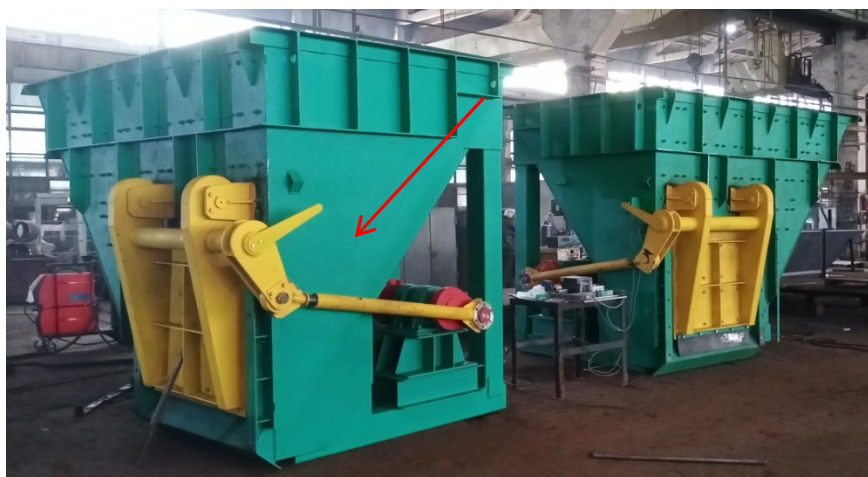
Рисунок 1 – Общий вид весоизмерительного устройства и обозначение мест нанесения знака утверждения типа и заводского номера
