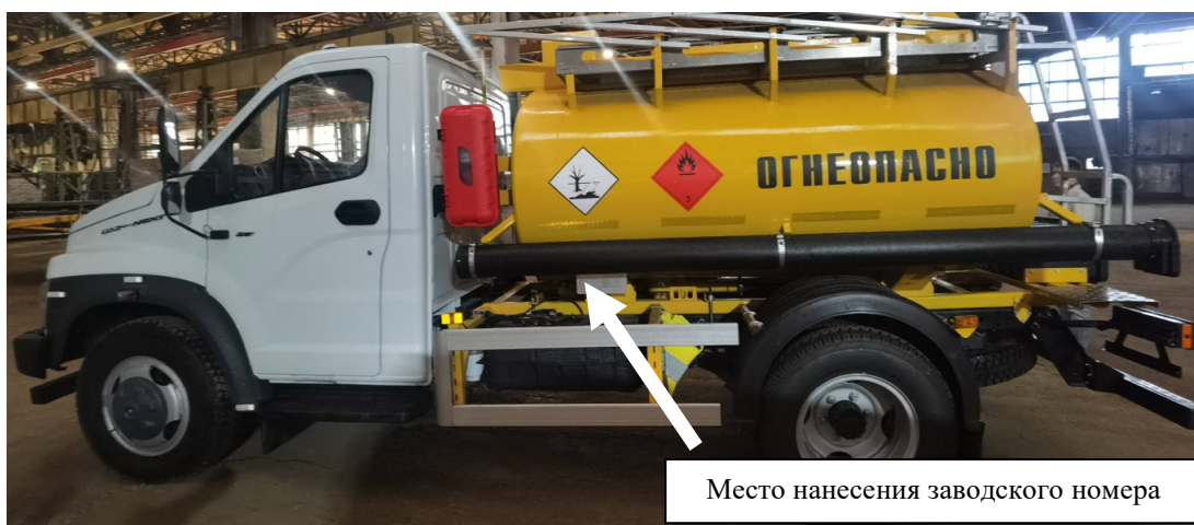
Рисунок 2 – Общий вид автоцистерны ГАЗ-САЗ-АЦ с обозначением места нанесения заводского номера
