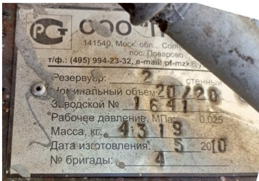
Рисунок 1 – Маркировочная табличка резервуара
