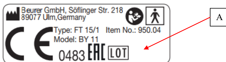
Рисунок 2 – Место нанесения заводского номера (А)
