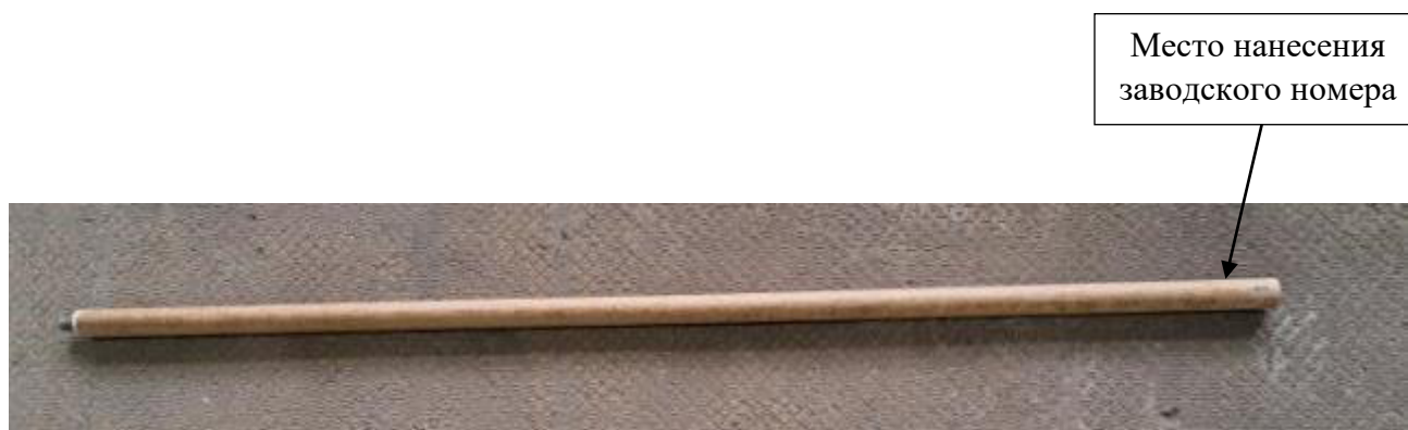
Рисунок 1 – Общий вид преобразователей термоэлектрических одноразового применения ТП 01200 с указанием места нанесения заводского номера
