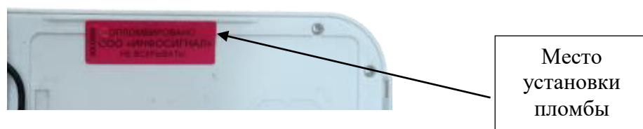
Рисунок 2 – Схема пломбировки модуля
