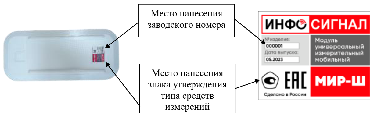
Рисунок 3 – Места нанесения на корпусе модуля заводского номера и знака утверждения типа средств измерений
