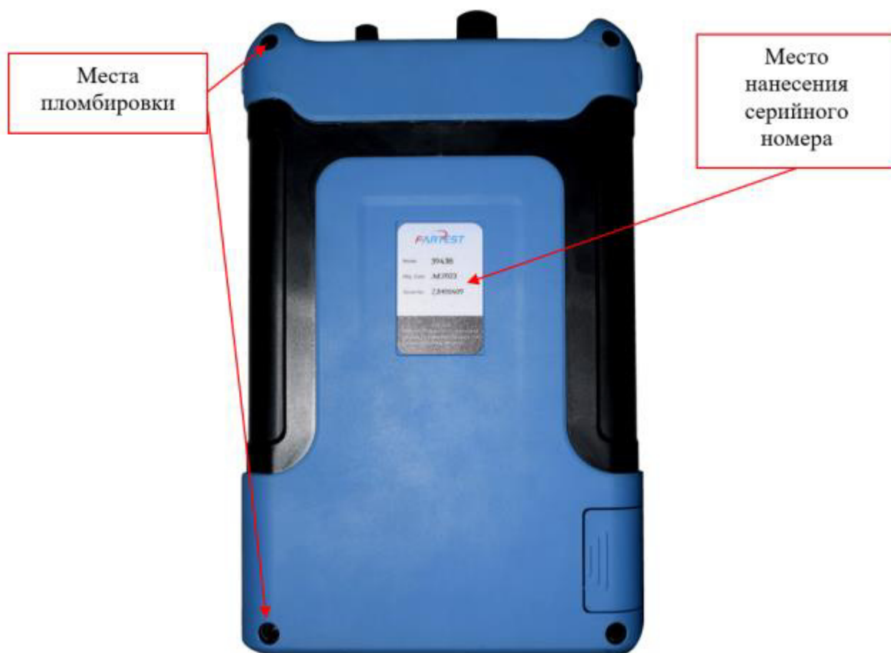
Рисунок 2 – Схема пломбировки от несанкционированного доступа и место нанесения серийного номера, идентифицирующего каждый экземпляр средства измерений
