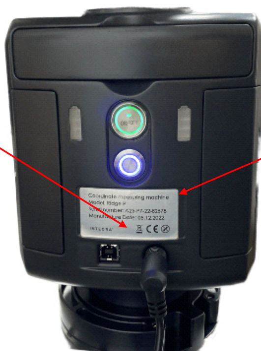
Рисунок 3 – Места нанесения маркировочной наклейки с заводским номером и знака утверждения типа средства измерений
