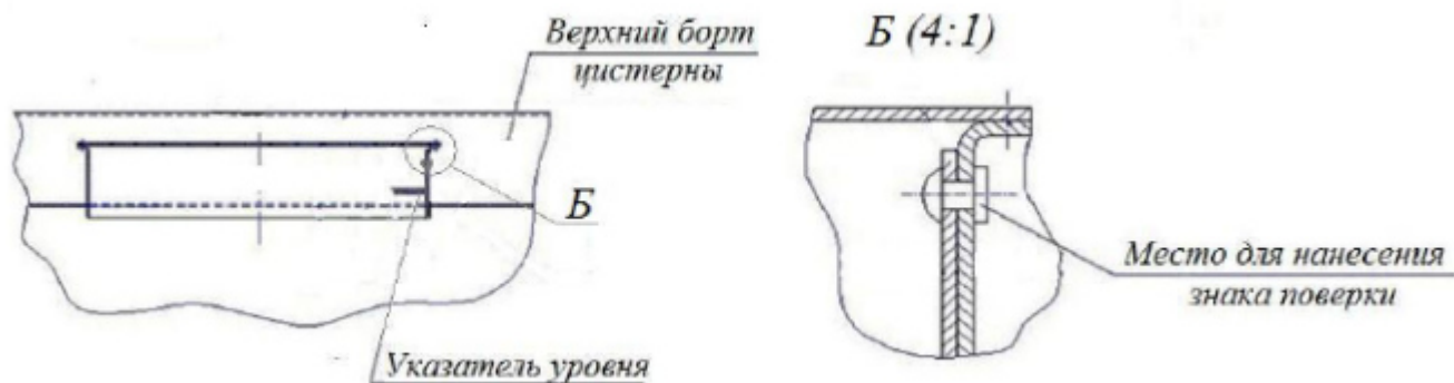
Рисунок 3 – Схема пломбировки от несанкционированного изменения положения уровня налива, обозначение места нанесения знака поверки
