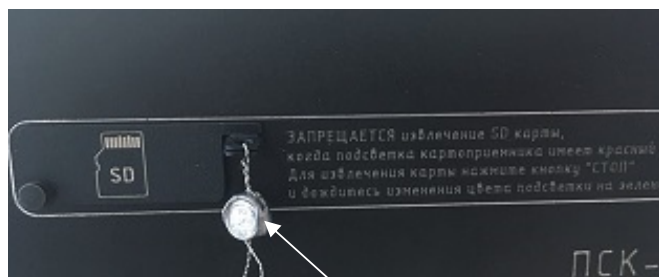
Рисунок 4 – Пломбирование слота с картой памяти
