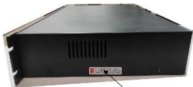
Рисунок 5 – Пломбирование корпуса контроллера
