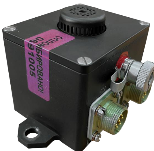
Рисунок 2 - Схема пломбировки датчика
