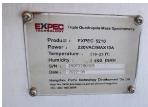
Рисунок 2 – Общий вид информационной таблички (шильдика)
