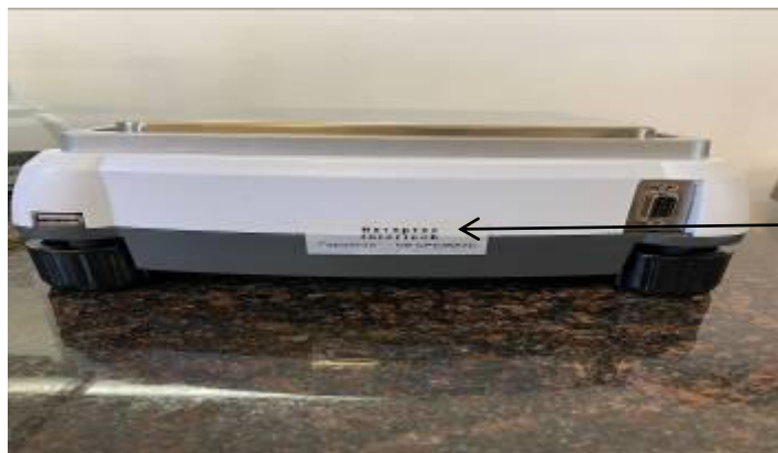
Рисунок 3 – Схема пломбировки от несанкционированного доступа
