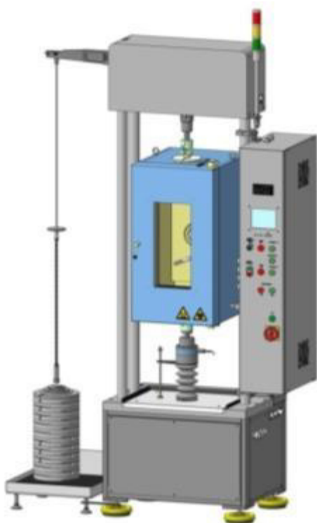
Рисунок 7 – Общий вид машин ТС ДП-3-Р-Х-У-ГР/1 (нижнее расположение рычажной системы)
