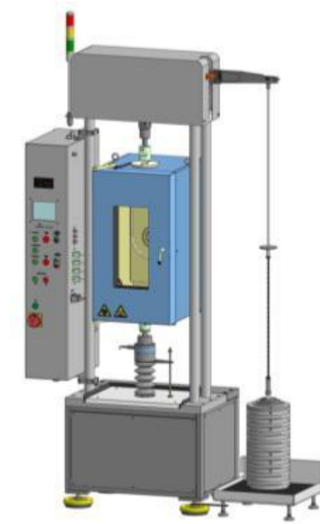
Рисунок 7 – Общий вид машин ТС ДП-3-Р-Х-У-ГР/1 (нижнее расположение рычажной системы)
